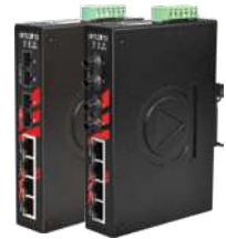
Serie LNP-0602 (Conector SC/ST) Conmutadores industriales PoE+ 6 puertos 10/100TX con 2 puertos de fibra
