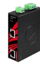
INJ-0200G-60-24-T Inyector Gigabit IEEE 802.3bt Tipo 3 4PPoE industrial
