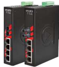
Serie LNP-0501 Conector SC/ST Conmutadores industriales PoE+ 5 puertos 10/100TX con 1 puerto de fibra
